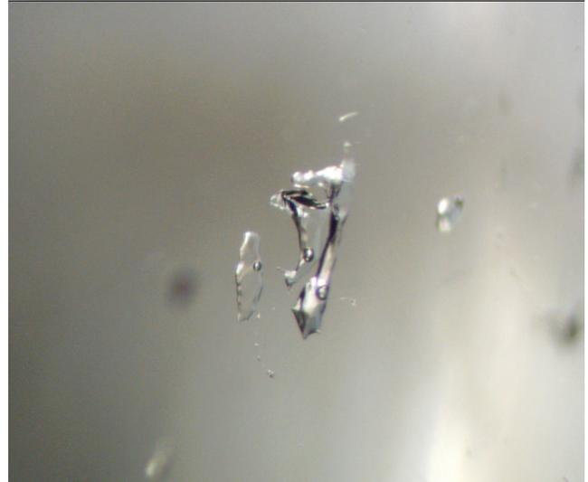
**Figure 2 :** À gauche : Figure optique « bull's eye » observée sous polariseurs croisés. À droite : Les inclusions biphasées démontrent que le quartz a une origine naturelle (Largeur du champ : 2.8 mm). Photos S. Riou & A. Delaunay.
