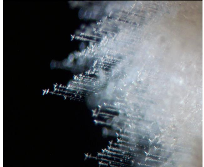
**Figure 4 :** a) Détail des « boules » montrant qu'il s'agit de lignes d'éclatements (Largeur du champ : 5,5 mm) b) Chaque « ligne » est finie par un éclatement plus important (Largeur du champ : 5 mm). Photos A. Delaunay.
