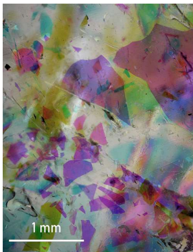
Figure 7 : Dislocation des lamelles sous l'effet du fluage de la matrice résineuse. Photo : J.-P. Gauthier.
