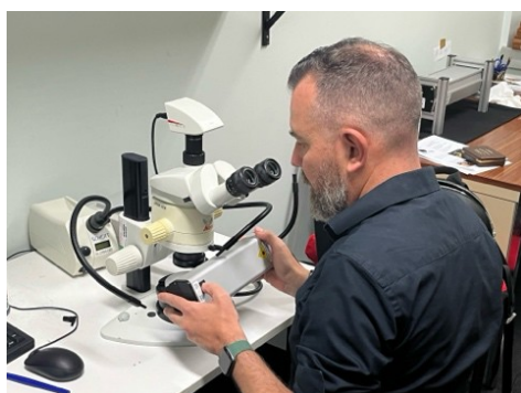
Figure 9 : Mise en place du dispositif de prise de photographie sous UVC
