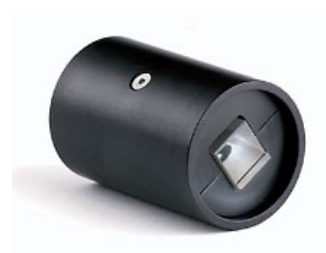
Figure 11 : Détail d'un polariseur à calcite gemme Glan Thompson tels que ceux utilisés dans le Perkin Elmer de la figure 10
