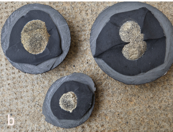
Figure 3 : Sciage des nodules : a) de part en part ; b) sur le pourtour seulement, puis fracturation. Photos : Élodie Miguet.
