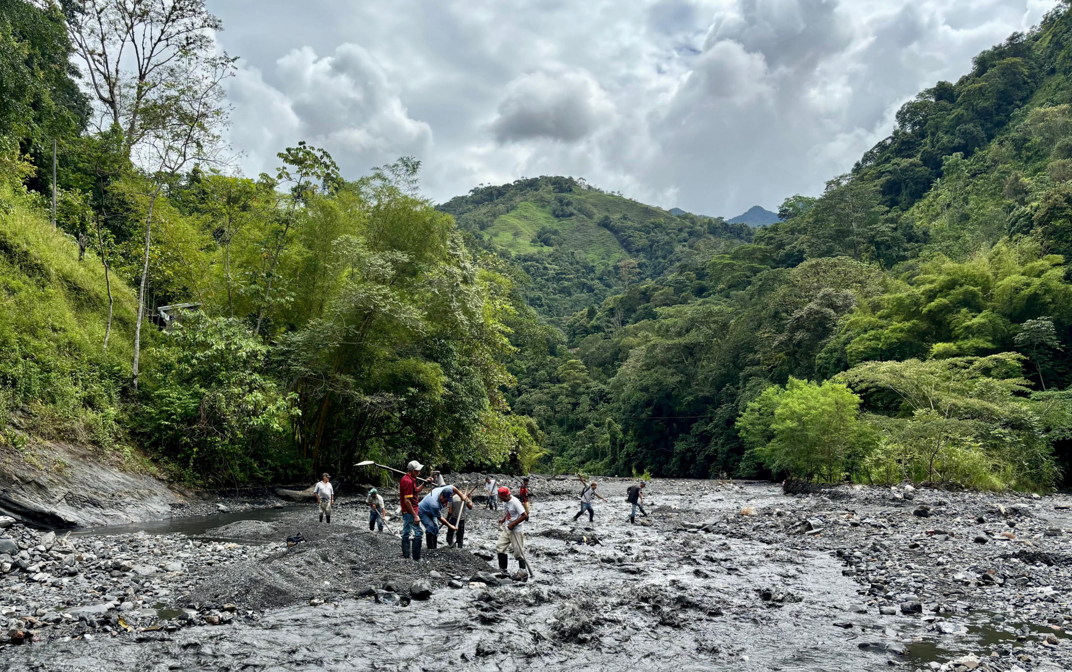
Figure 5 : Mineurs à la recherche d'émeraudes dans le lit de la rivière du Río Itoco, municipalité de Quípama. L'extraction s'effectue à l'aide de pelles et de pioches. Photo : Claire Chapuis.
