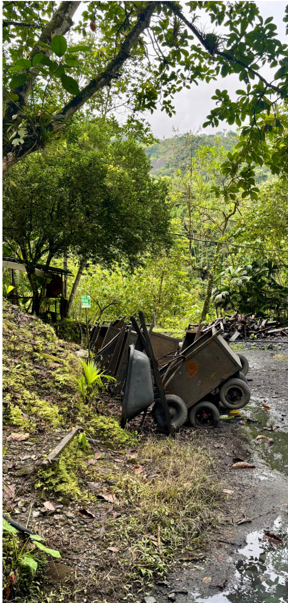
Figure 2 : Berlines de mine (wagonnets) servant à l'extraction du minerai. Municipalité de Quípama. Photo : Claire Chapuis.
