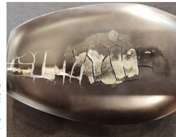
Figure 8 : Les fissures perturbent la masse pyriteuse (longueur : 18 cm, largeur : 9,5 cm, épaisseur : 4 cm, masse : 1,3 kg). Photo : J.-P. Gauthier.
