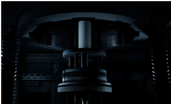
Figure 2 : La matrice en carbure de bore prend forme dans un moule cylindrique, soumis à une forte pression, ©Hublot.
