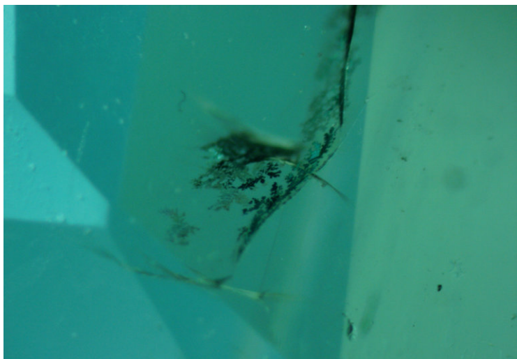
Figure 8 : Fissure avec dendrites, vestiges d'un remplissage ancien, probablement à l'huile de cèdre. Largeur de champ : 2,8 mm environ. Photo : A. Delaunay.
