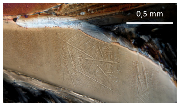
Figure 8 : Dendrites en surface de cristaux. Photo : J.-P. Gauthier.
